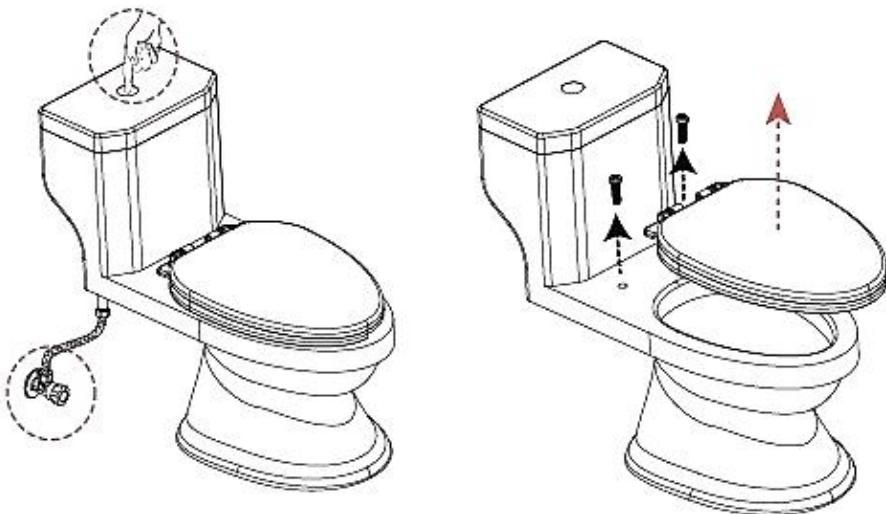
1. Перекрыть подачу воды, спустить воду в унитазе, чтобы слить бачок.
